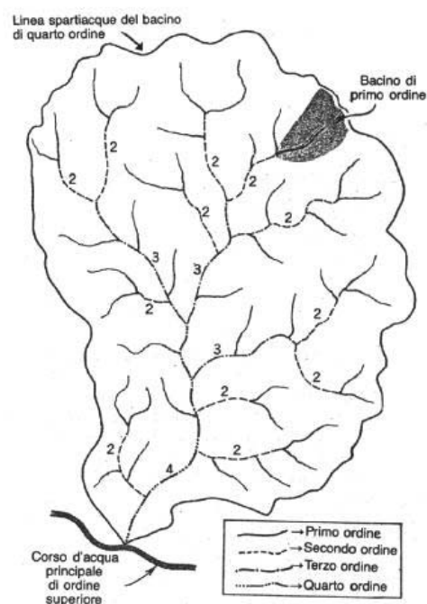
Fig. 1.7 - Schema della gerarchizzazione di un reticolo idrografico
